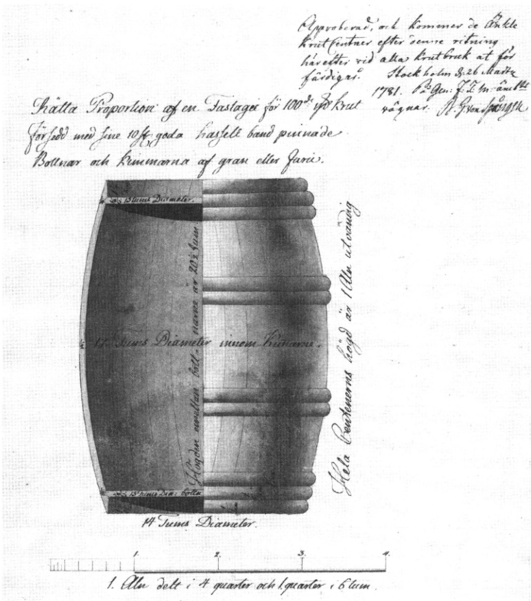
Bild 4. "Approberad, och kommer de Enkle KrutCentner efter denne ritning härefter vid alla krutbruk att förfärdigas" (ovan till höger). "Rätta Proportion af en Fastage för 100de skålpund krut försedd med sine 10st goda hassel band pinnade Bottnar och kimmarna af gran eller furu" (ovan). Hela Centnernas höjd är 1 aln (59,4 cm) utvändigt och 14 tum (1 tum motsvarar 2,47 cm) i diameter. Krigsarkivets fotosamling. 14
