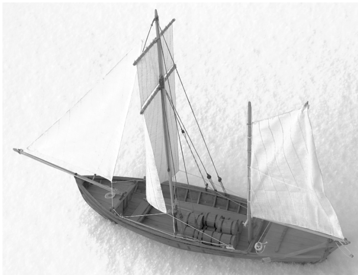
Figur 1. Modell av slup (skala 1:15) av Anders Svedelius, Holmsund. Båtbenämningen slup avsåg under 1800-talet vid Västerbottenskusten en cirka 10–12 meter lång, enmastad res- eller fraktbåt. En replik av en handelsmans slup på Holmön går sedan 2001 i trafik mellan Holmön och STF-vandrarhem Stora Fjäderägg. Foto Annika Sandström, Holmöns båtmuseum.
