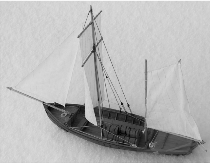
Figur 2. Modell av haxe (skala 1:30) av Anders Svedelius, Holmsund. Båtbenämningen haxe (på Holmön dial. hakste ) betecknade inte någon mer specifik fartygstyp utan avsåg hela den grupp av olika lastfartyg under segel som ombesörjde Kvarkens och Bottenvikens nyttotrafik. Lastutrymmet i både slup och haxe var helt öppet men i enstaka fall begränsat av en mindre kajuta i aktern. Foto Annika Sandström, Holmöns båtmuseum.
