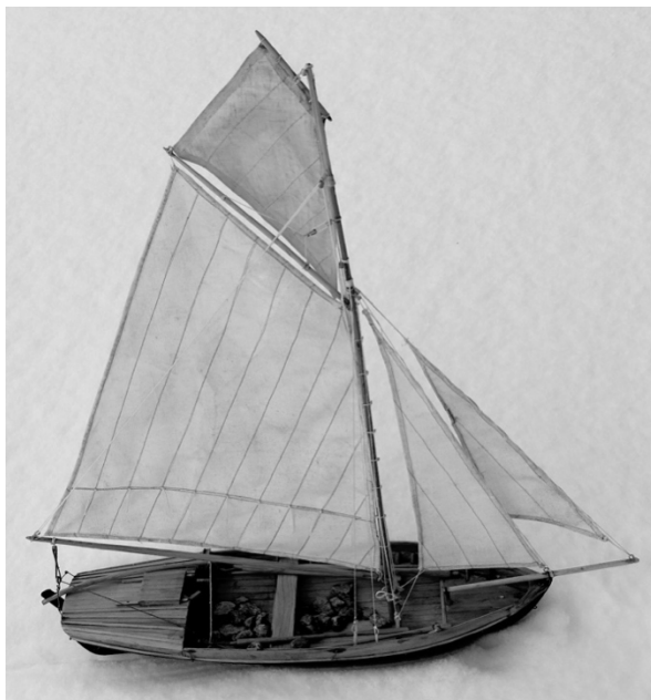
Figur 1. Modell av slup (skala 1:15) av Anders Svedelius, Holmsund. Båtbenämningen slup avsåg under 1800-talet vid Västerbottenskusten en cirka 10–12 meter lång, enmastad res- eller fraktbåt. En replik av en handelsmans slup på Holmön går sedan 2001 i trafik mellan Holmön och STF-vandrarhem Stora Fjäderägg. Foto Annika Sandström, Holmöns båtmuseum.
